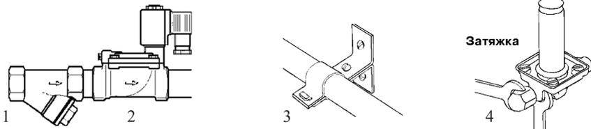
1. Перед монтажом клапана трубопроводы должны быть прочищены, т.к. попадание в клапан инородных частиц может привести к выходу его из строя. Перед входным отверстием соленоидного клапана необходимо установить фильтр-грязевик.
