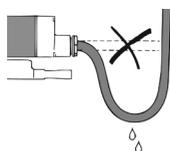
**Внимание!** Вода не должна проникать в клеммную коробку. Кабель необходимо монтировать с образованием петли для стекания капель жидкости.
